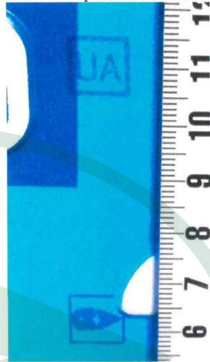
Зображення 1.128. Збільшене зображення елементів додаткового ідентифікаційного зображення на світлоповертальній плівці номерного знаку «2468» розмірами 220x174 мм.
