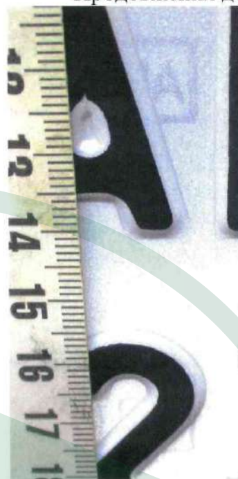
Зображення 1.56. Збільшене зображення елементів додаткового ідентифікаційного зображення на світлоповертальній плівці номерного знаку «AA1234DA» розмірами 140x114 мм.
